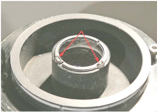
Fig. 17 (a destra) – Una lente di forte curvatura poggia sulla spalla interna del barilotto (S) ed è serrata dall’anello a due tacche che si vede in basso a sinistra.
