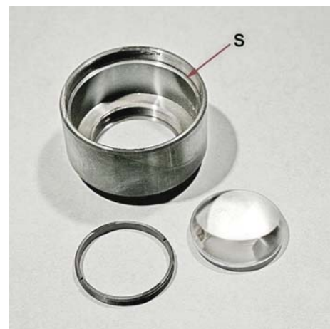
Fig. 17 (a destra) – Una lente di forte curvatura poggia sulla spalla interna del barilotto (S) ed è serrata dall’anello a due tacche che si vede in basso a sinistra.
