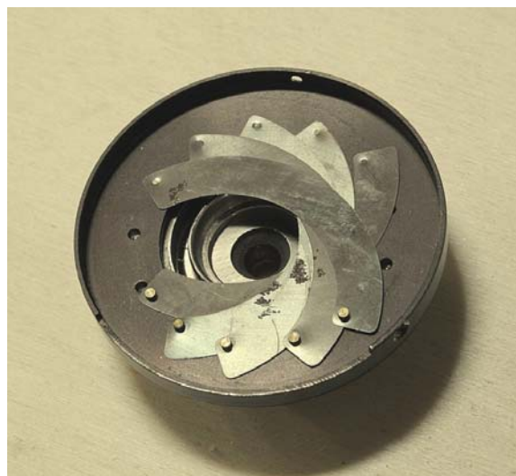
Fig. 344 – L'anello a fori con una parte delle lamelle, poggiato sul magnete a coppa munito di rondella ed anello centrale in ottone. La stabilità nella posizione delle lamelle dipende dall'intensità del campo magnetico. Se questo è troppo forte, basta poggiare sul magnete un pezzo di cartoncino. Se è troppo debole, occorre cambiare magnete.
