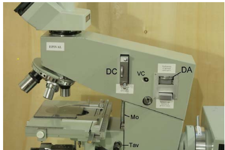
Fig. 346 – Il microscopio episcopico Epival della Zeiss (Jena) in cui sono visibili vari organi dell’illuminatore episcopico, in particolare il cursore (DA) che porta il diaframma d’apertura.
