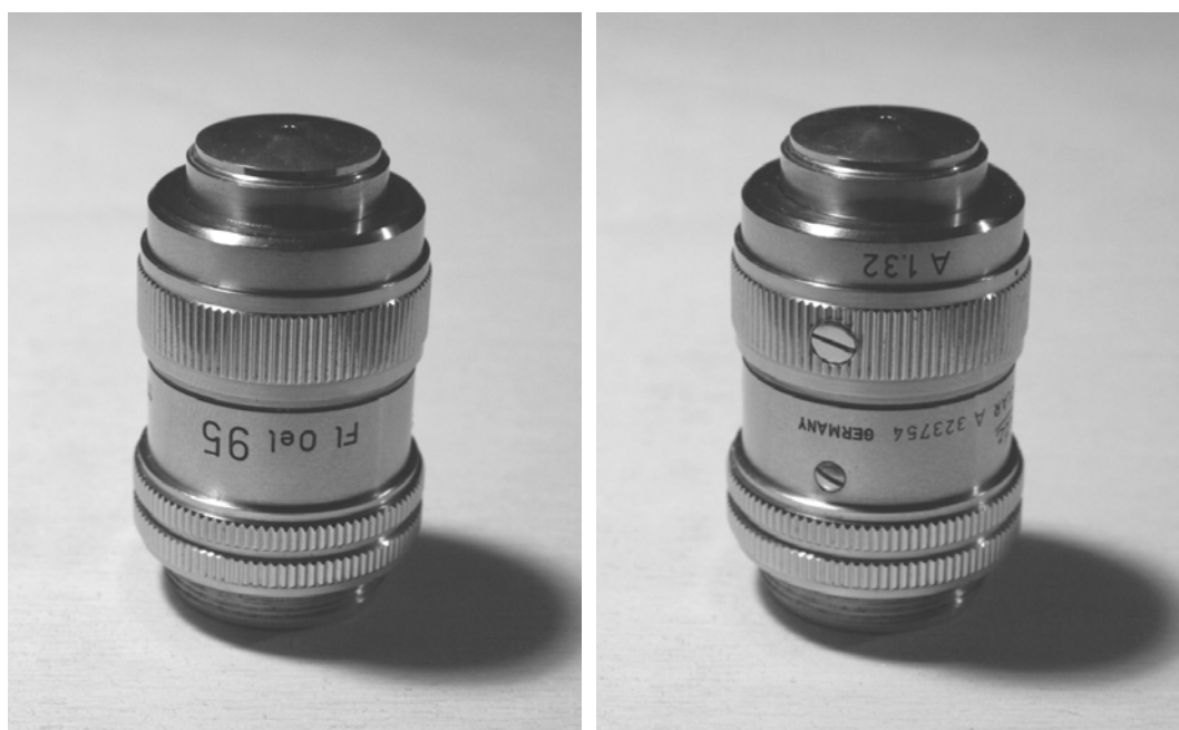
Figg. 300 e 301. – L’anello godronato doppio, in basso, serve ad avvitarlo nella sua sede. L’anello in alto serve per regolare il diaframma; se, inavvertitamente, si afferra tale anello mentre si avvita l’obiettivo, si rischia di sforzare e danneggiare il meccanismo del diaframma.
