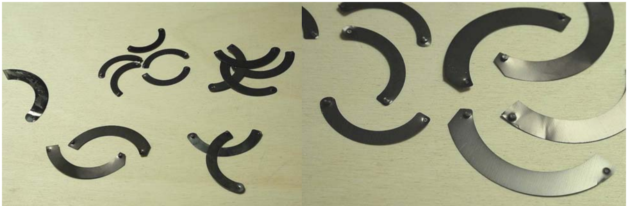
Figg. 332 e 333 – Vari esempi di lamelle; ben visibili i pernini alle due estremità di ogni lamella. All'estrema destra si vede una lamella malamente spiegazzata per maldestra manipolazione.
