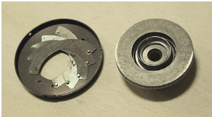
Fig. 343 – Il magnete a coppa della fig. 341, a destra, munito di una grossa rondella in ferro che ne allarga il diametro esterno.
