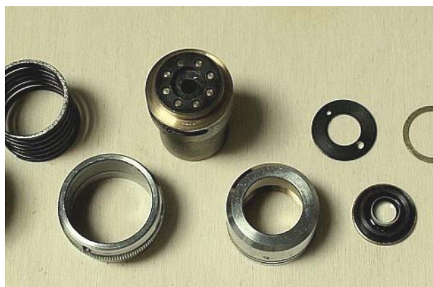
Figg. 337 e 338 – Diaframmi ad iride inglobati all’interno di obiettivi di apertura superiore ad 1.0.
