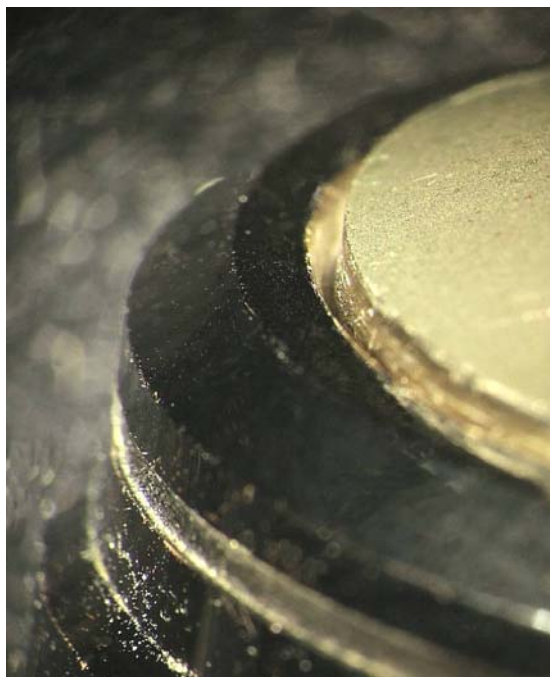
Fig. 326 – Appare evidente il solco scavato fra le due parti cementate, che ora sono separate da una fessura. Basterà?
