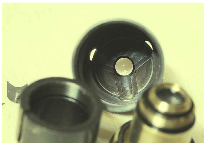
Fig. 316 – In fondo al barilotto B (fig. 314) vi è una lente e tre scanalature radiali, destinate allo scorrimento delle lamelle del diaframma, visibili nella foto 315.
